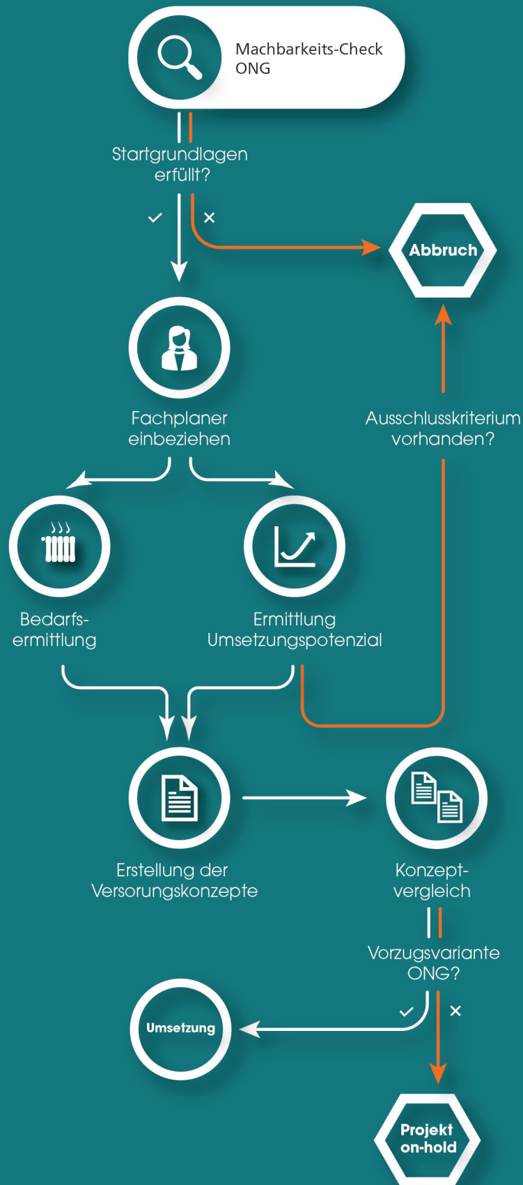
Abbildung 7: Prozessschritte für die Entwicklung von Versorgungskonzepten mit EWS
