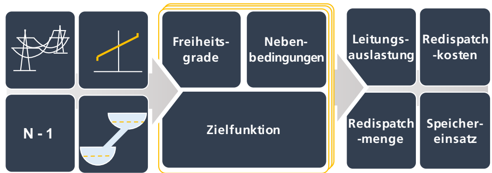
Abb. 5-9: Verfahrensablauf der Netzbetriebssimulation
