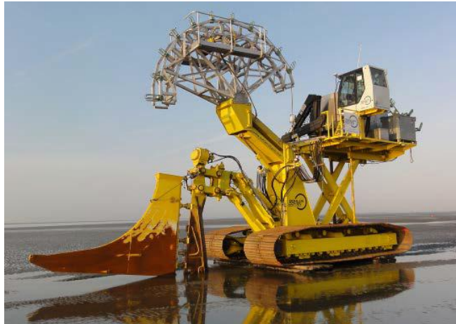
Abbildung 4-9: Kabelpflug zur Seekabelverlegung im Wattenmeer 233
